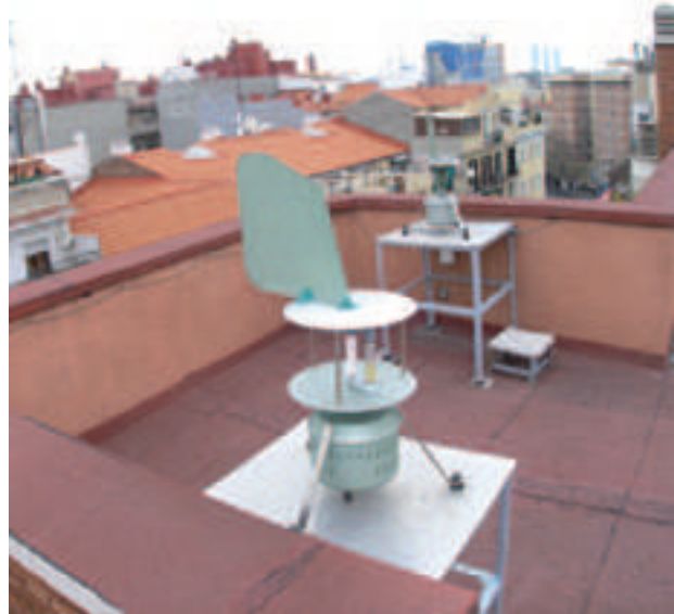
Colectores Burkard, empleados por los especialistas para la detección de pólenes y aeroalérgenos, instalados en una azotea.
