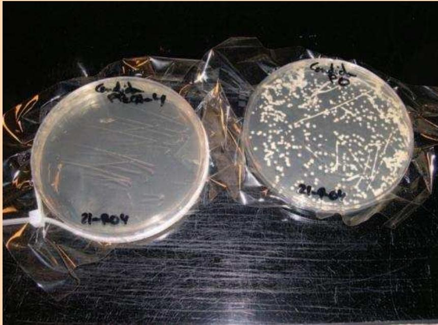
Figura 7. Ensayo realizado con *Candida albicans* y lámina de PP con extracto antimicrobiano
